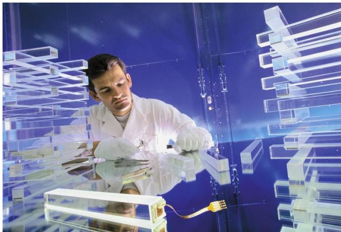
**Figura 1** – I cristalli scintillatori per rivelatori di particelle (in questo caso, per l'esperimento CMS presso LHC) sono usati anche negli scanner PET. Foto di Peter Ginter (2004). Credit: CERN ([cds.cern.ch/record/808282](http://cds.cern.ch/record/808282)).
