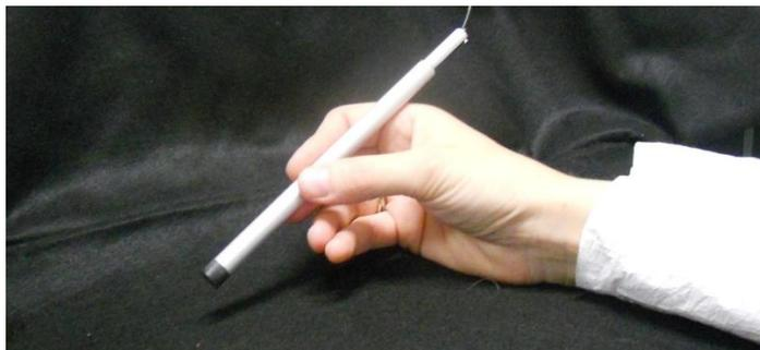
**Figura 2** – Prototipo della sonda che, avvolta in una copertura sterile, dovrebbe utilizzare il chirurgo durante l'operazione per verificare la completezza dell'asportazione.
