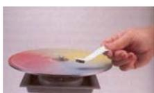
**Cosa sono le correnti di Foucault?** Le correnti indotte si generano anche all'interno di corpi metallici massicci, come nel caso del nostro esperimento. In questa circostanza prendono il nome di Correnti di Foucault. Secondo la Legge di Lenz, anche in questo caso le correnti indotte danno origine a una forza magnetica di repulsione nei confronti del magnete, forza che fa sì che il magnete leviti sopra il disco di alluminio.
