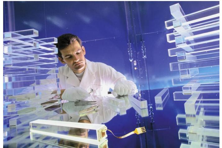
**FIGURE 1** – Les cristaux scintillateurs pour les détecteurs de particules (dans ce cas, pour l'expérience CMS au LHC) sont également utilisés dans le scanner TEP. Photo de Peter Ginter (2004). Credit : CERN ([cds.cern.ch/record/808282](http://cds.cern.ch/record/808282)).
