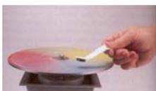
**Qu'est-ce que les courants de Foucault ?** Les courants de Foucault sont générés dans des corps métalliques massifs, comme dans le cas de notre expérience. Selon la Loi de Lenz, dans ce cas les courants de Foucault créent une force magnétique répulsive vers l'aimant, et cette force permet à l'aimant de léviter sur le disque en aluminium.
