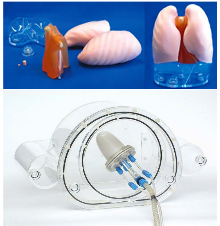
Figura 1 – Diferentes tipos de phantoms, representando en ambos casos el pecho humano. El de la parte superior representa las estructuras anatómicas del pecho con los huesos, pulmones y otros tejido blandos. Créditos: www.kyotokagaku.com . El de la parte inferior es un phantom cardíaco dinámico representando la fisiología del corazón humano. Créditos: www.ptw.de .
