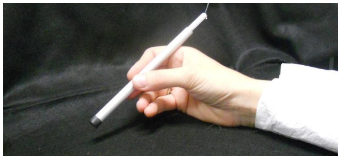
Figura 2 – Prototipo de la sonda que, envuelta con una cubierta estéril, usaría el cirujano durante la operación para verificar la total extirpación.
