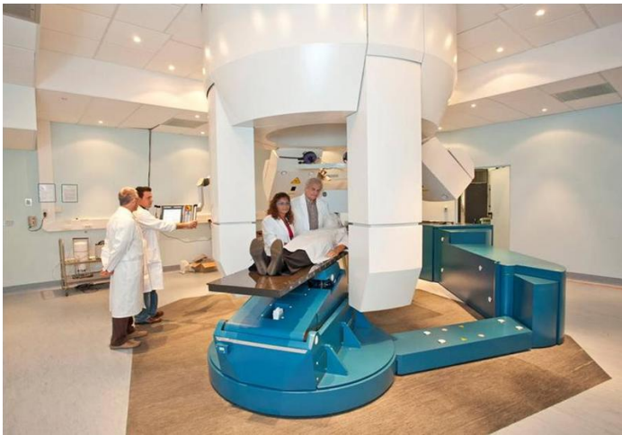
Figura 2 – Sistemas de posicionamiento y verificación del paciente en uno de los tres salones de tratamiento del CNAO. Créditos: ENLIGHT.
