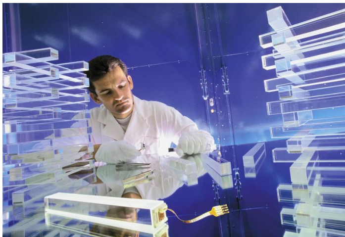
Figura 1 – Los cristales centelleadores para detectores de partículas (en este caso, para el experimento CMS en LHC) también se utilizan en el escáner PET. Fotos de Peter Ginter (2004). Credit: CERN (cds.cern.ch/record/808282).
